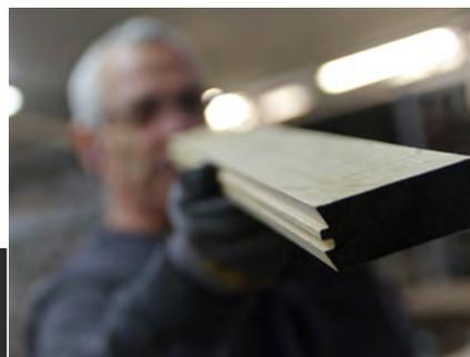
PLUS DE **MICRO-OXYGÉNATION** GRÂCE À LA TECHNIQUE DU **BOUVETAGE**
