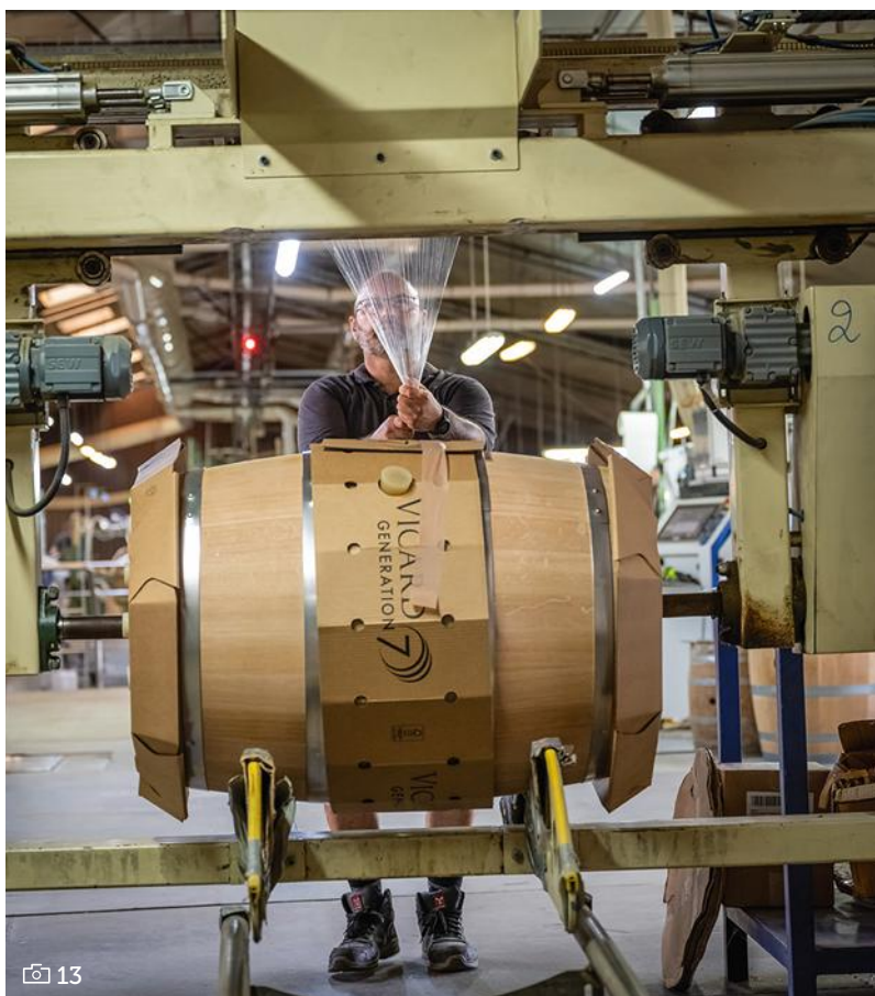
📷 13. FILMEUSE AUTOMATIQUE de la barrique et mise en place de cartons pour protéger les parties les plus exposées lors du transport, les barriques pouvant être expédiées à l'étranger.
