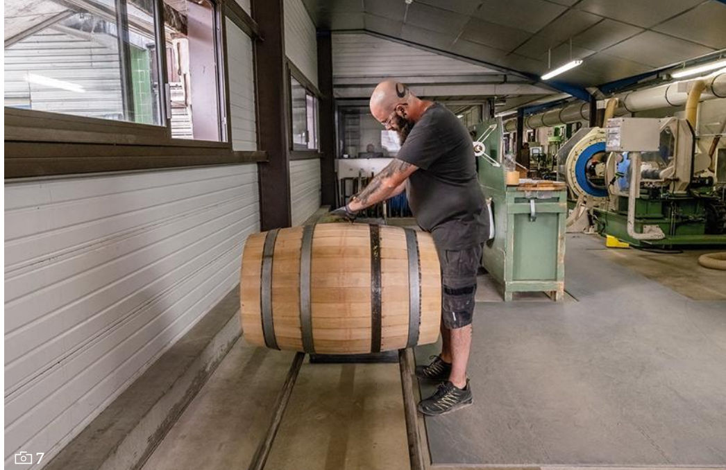
7. POUR PASSER d'un atelier à un autre après qu'ils ont pris leur forme quasi définitive, les tonneaux suivent un cheminement légèrement incliné, évitant le port de charges.
