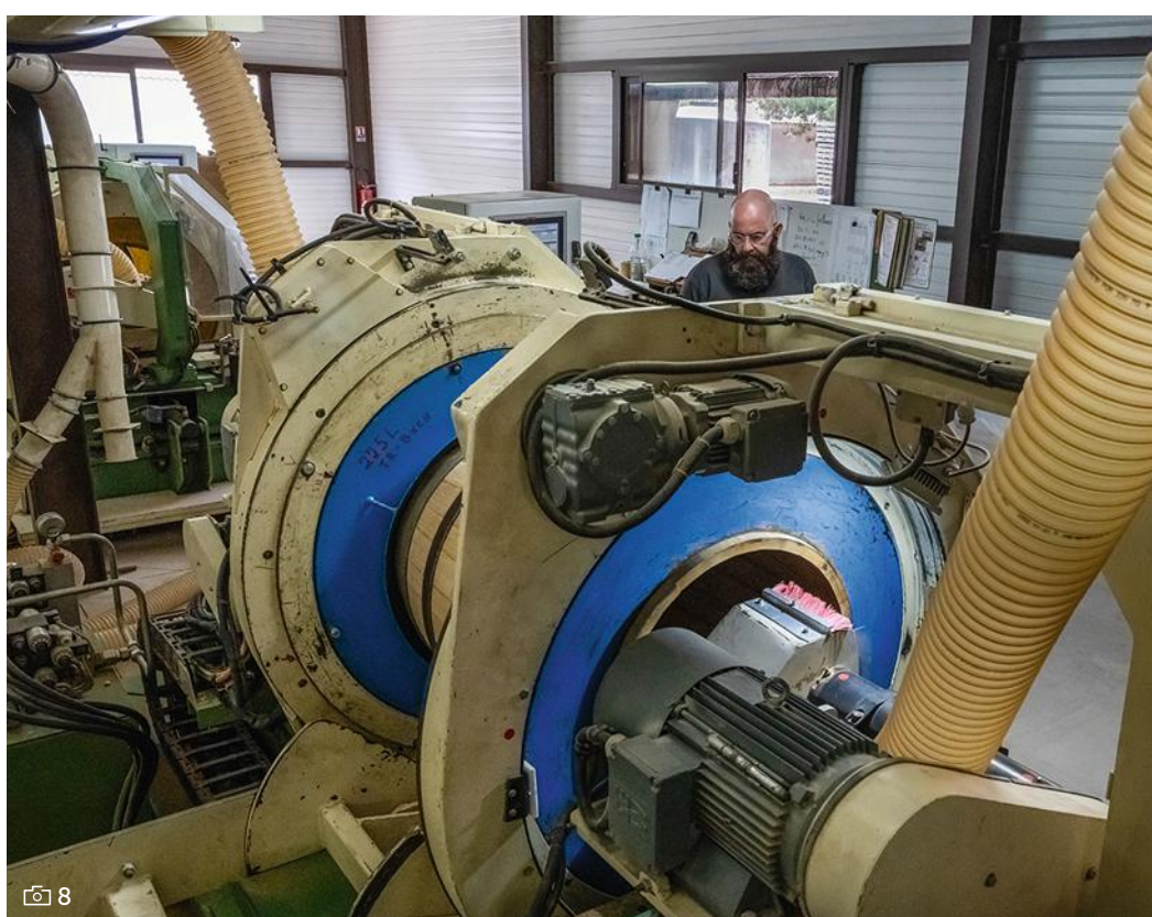
8. ROGNAGE DES BARRIQUES , avec une machine équipée d'une aspiration centralisée.
